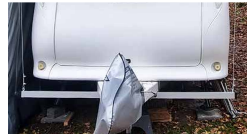
Rechteckrohr zur vorderen Abspannung des MTH-Schutzdachs für optimalen Halt.
